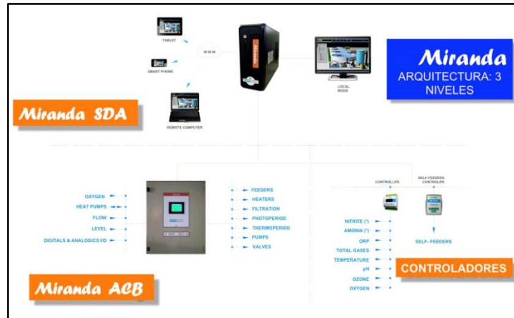
Figura 12. Sistema de control Miranda
