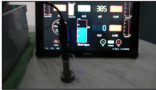
Figura 88. Comprobación calibración OD
