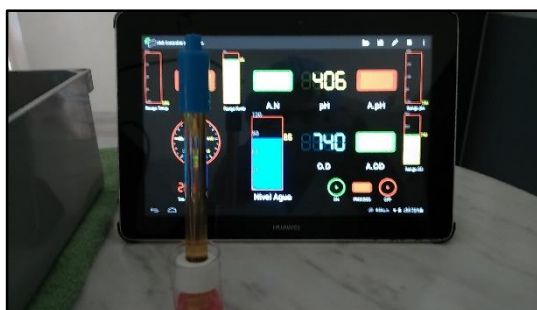
Figura 87. Comprobación calibración pH
