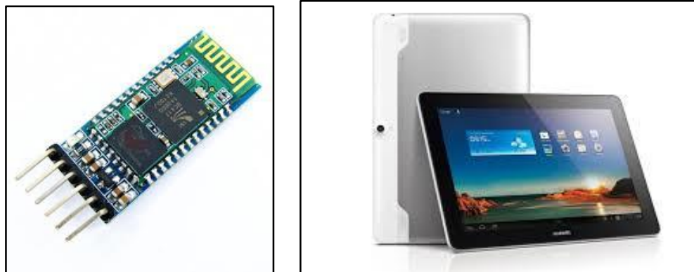
Figura 73. Módulo Bluetooth HC-05 y tableta
