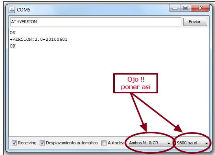
Figura 98. Monitor serial Arduino para enviar códigos AT
