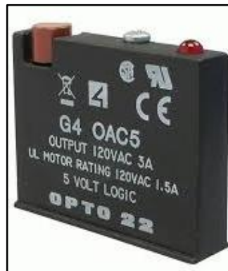
Figura 57. Relé de estado sólido empleado para actuadores y alarma
